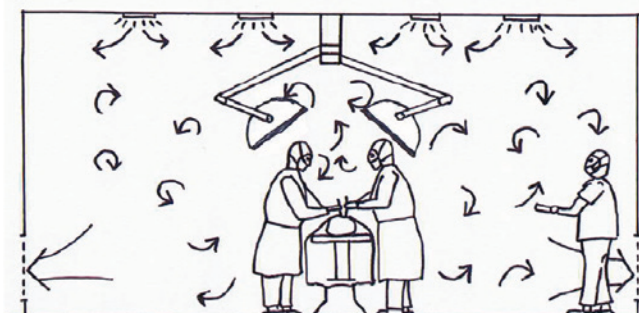
Abbildung 3: Mischlüftung mit überall gleicher Mischluftqualität.
