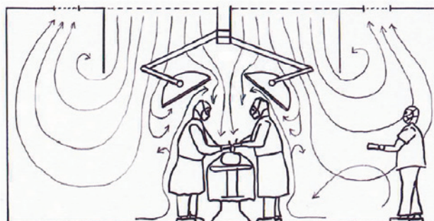
Abbildung 2: Fast unwirksame Verdrängungslüftung infolge übergrosser OP-Leuchten und Umluftfassungen nahe des TAV-Feldes in der Decke.
